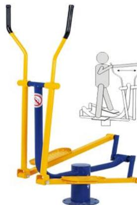
**Materiais:** Estrutura principal confeccionada em tubos de aço carbono de no mínimo 3' ½ x 3,75 mm; 2' ½ x 2 mm; 2' x 2 mm 1' ½ x 3 mm; 1 ½ x 1,50 mm; 1' x 2 mm. Chapas de aço carbono com no mínimo 4,75 mm; 1,90mm; Metalão de no mínimo 30mm x 50mm x 2 mm. Barra chata de no mínimo 3/16" x 1' ¼. Tampão embutido interno em plástico injetado de no mínimo 2' ½" com acabamento esférico.
